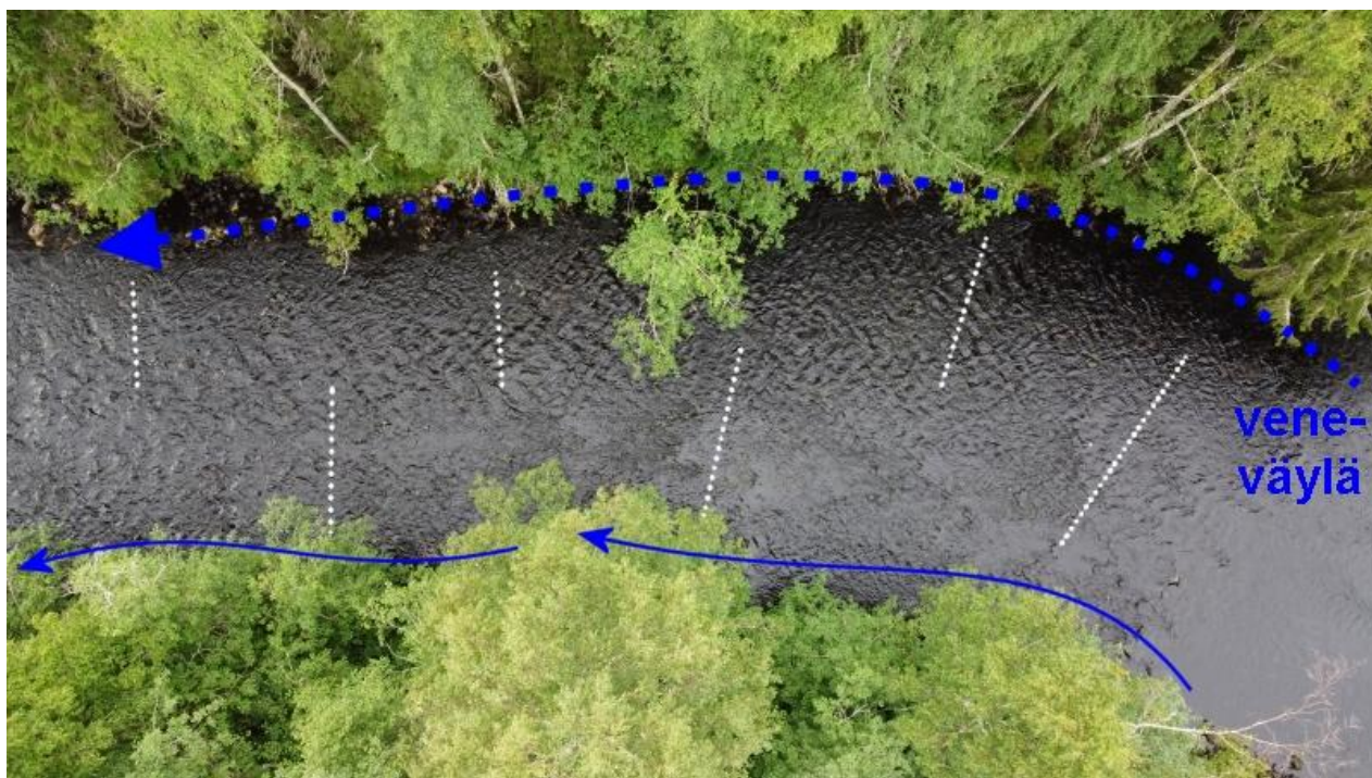
Ilmakuva 4. Kuvassa näkyy saaren ja länsirannan välisen koskenosan ylävirranpuoleinen osuus. Uomaan muokattavilla harvoilla kynnysmäisillä rakenteilla (valkea pisteviivoitus) on tarkoitus sekä lisätä vesisyvyyttä että monimuotoistaa virtausta.
